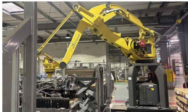
Ce bras motorisé doit empiler les cartons sur des palettes.
